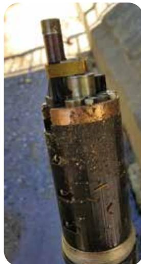
Abb 2: Fouling nach Sturmereignis: Prototyp des Nitratsensors und der Sensorfixierung
