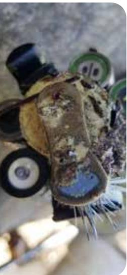
Abb. 1: EXO2 mit Bio-Fouling an Zentralwischer und Sensoren, links die gereinigten Sensorflächen
